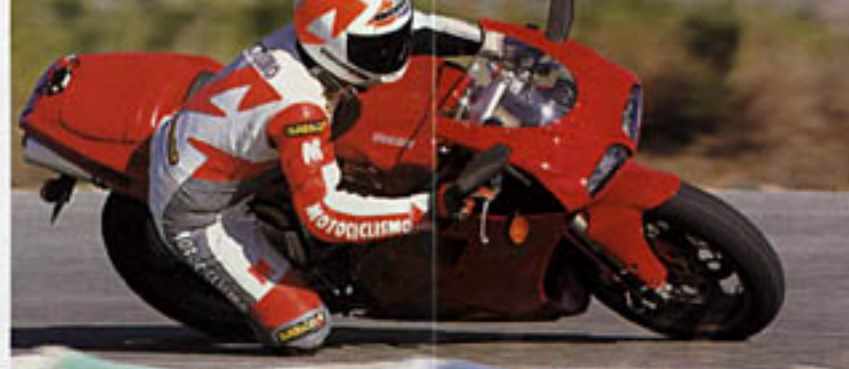
La Ducati es un perfecto ejemplo de suspensiones «tradicionales» de funcionamiento óptimo gracias a esa horquilla Showa de barras invertidas y al basculante monobrazo con amortiguador y bieletas.
