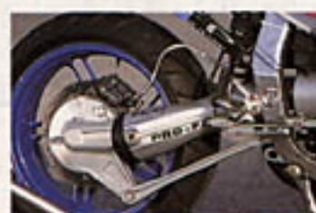
BMW desarrolló el Telelever pensando en motos pesadas y la verdad es que en esa aplicación es imbatible, consiguiendo que esta moto se defendiera notablemente en Calafat: horquilla «guiada» por basculante delante y basculante Paralever sin bieletas detrás.
